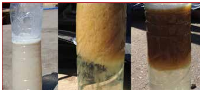
Фото 8. Сточные воды после механической решетки до обработки реагентом (слева), сточные воды после обработки реагентом (в центре и справа)
