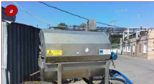
Фото 4 Барабанная решетка RTV (а), рабочая поверхность барабана (перфорированная сетка) (б)
