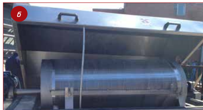
Фото 4 Барабанная решетка RTV (а), рабочая поверхность барабана (перфорированная сетка) (б)
